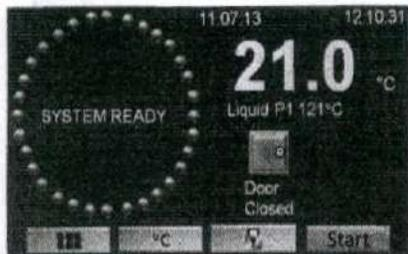
Экран, показанный слева, называется рабочим. На нем контролируется температура рубашки, загрузки и камеры. Текущие дата и время указаны в верхней строке. Для запуска выбранной программы нажмите кнопку ввода (F4). Во время работы информация о ходе выполнения программы отображается в виде круга, демонстрирующего процедуру завершения работы. Общее время отображается в верхней строке, название фазы указывается в строке ниже и время программы указано в нижней строке.
